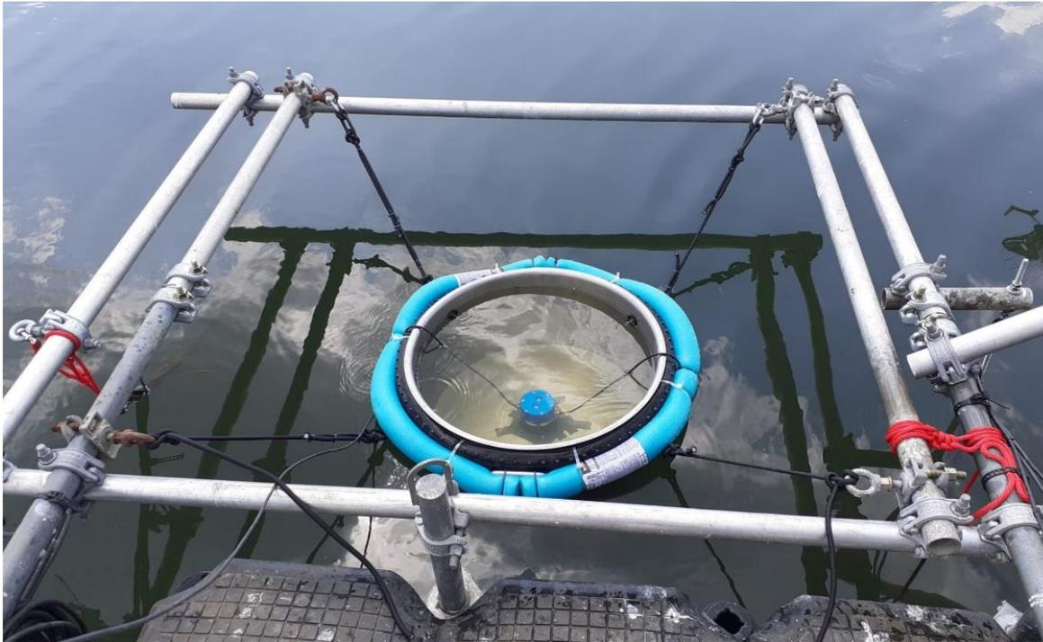
Schwimmend installiertes Lysimeter auf der Talsperre Bautzen im Rahmen des DFG-Projekts MEDIWA (2022)
