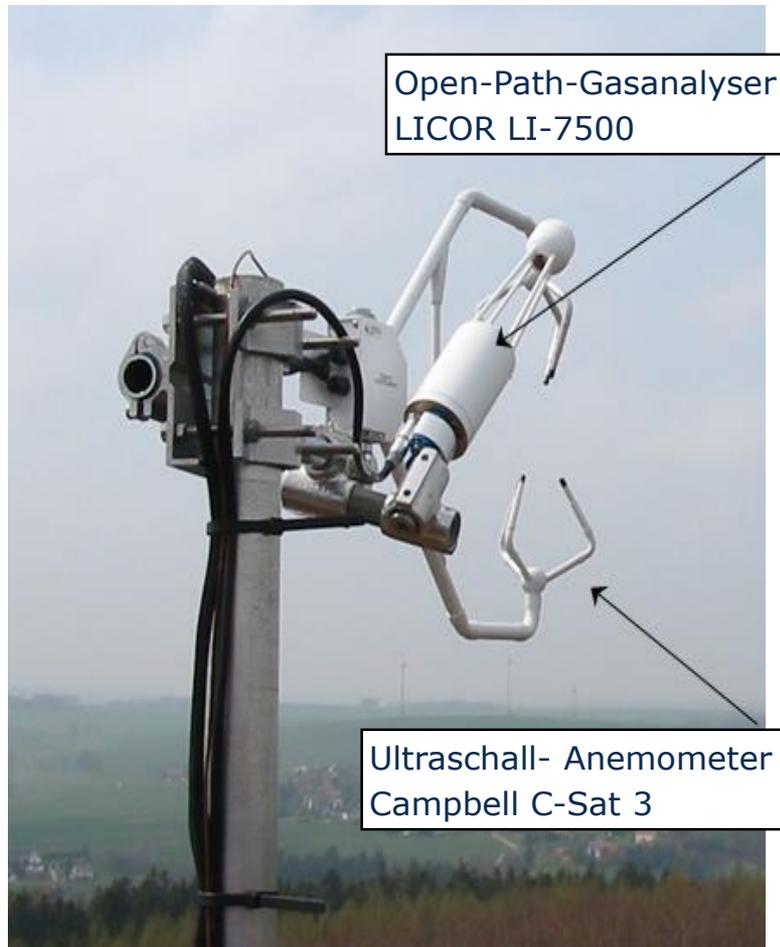
EC-Messanlage im Tharandter Wald zum Monitoring des Stoff- und Energieaustausch zwischen einem Buchenbestand und der Atmosphäre
