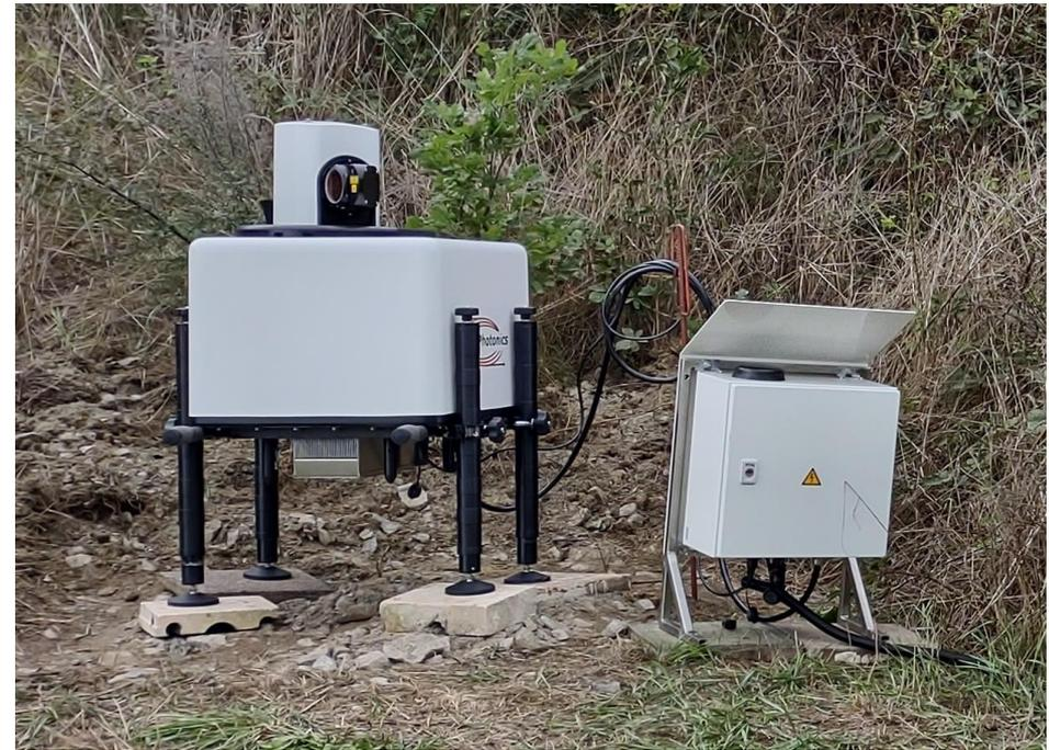
Halo Photonics Stream Line<sup>XR</sup> Scanning Doppler LIDAR beim Einsatz an der Talsperre Bautzen (September 2022)
