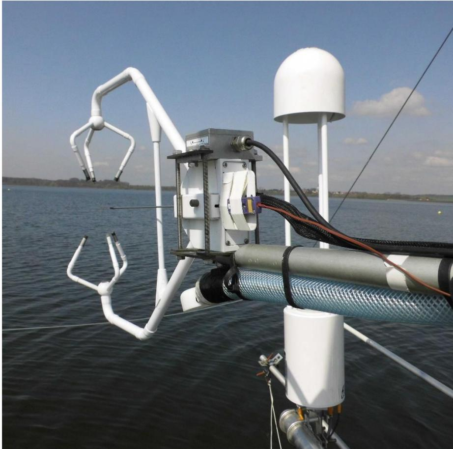
Auf der Talsperre Bautzen eingesetztes EC-Messsystem zum zeitlich hochaufgelösten Monitoring des sensiblen und latenten Wärmefluss, der Verdunstung und des Kohlendioxid- und Methanaustauschs zwischen Wasseroberfläche und Atmosphäre
