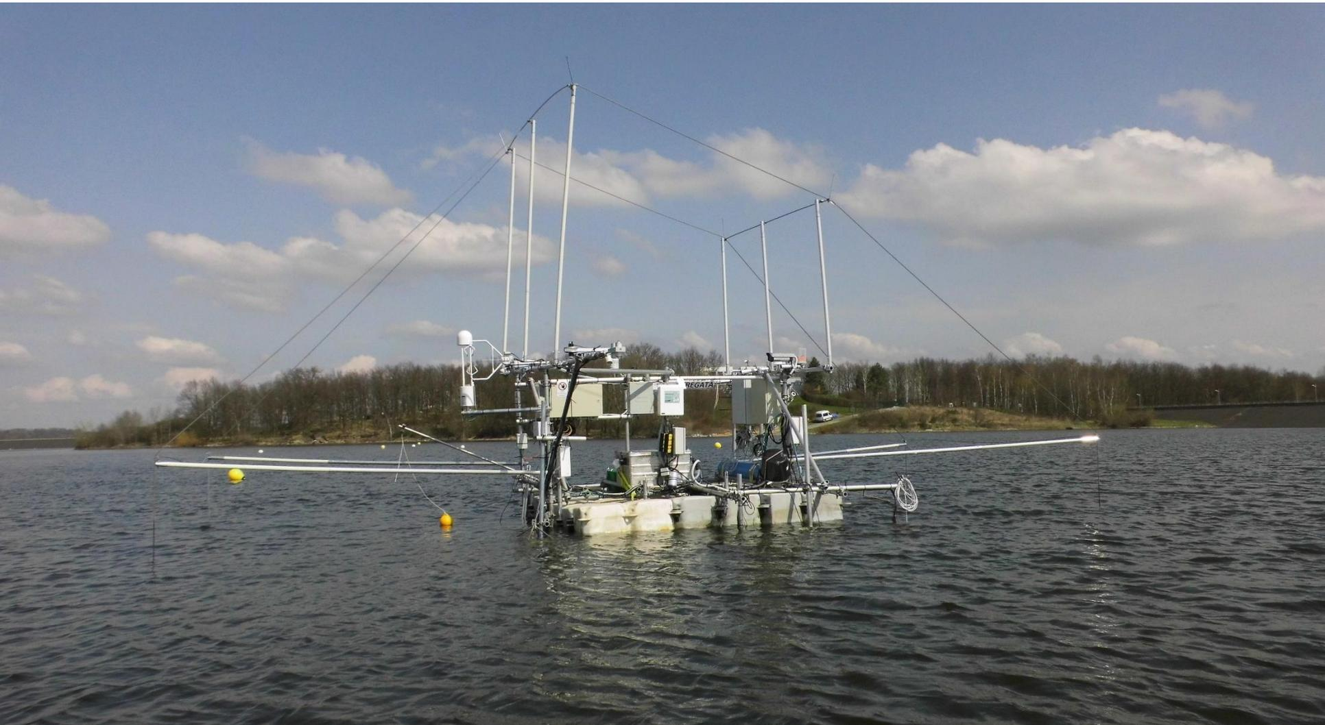
Schwimmendes Messlabor mit EC-Messsystem auf der Talsperre Bautzen zur zeitlich hochaufgelösten Messung des sensiblen und latenten Wärmefluss, der Verdunstung und des Kohlendioxid- und Methanaustauschs zwischen Wasseroberfläche und Atmosphäre
